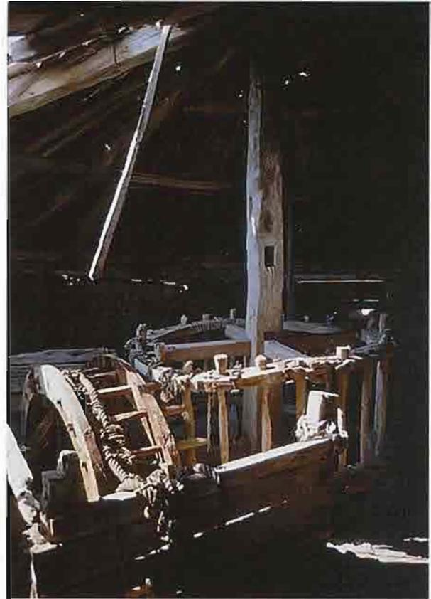
Fig. 406. Restos de noria de madera con la que se extraía el agua salada de uno de los pozos de las salinas de Imón (Guadalajara).
